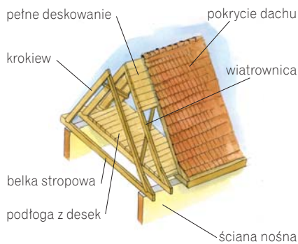
Dach o konstrukcji krokwiowej
