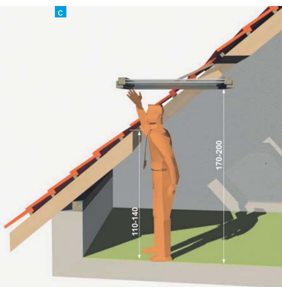
Okno obrotowe (a), okno uchylno-obrotowe (b), okno wysokoosiowe (c)
