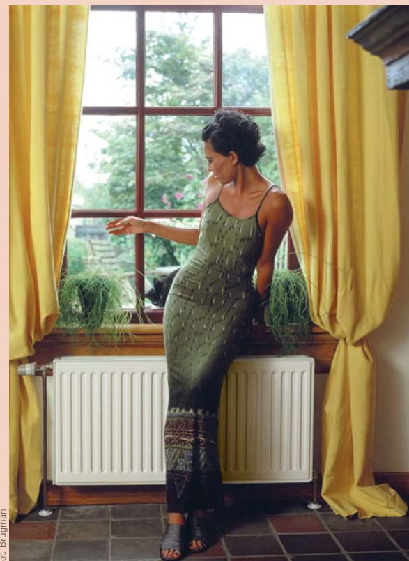
▲ Poprawne usytuowanie grzejnika pod oknem
