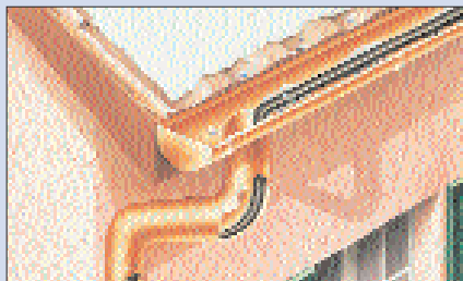
9 Przewód grzewczy umieszcza się bezpośrednio w rynnie i rurze spustowej (rys. Raychem)
