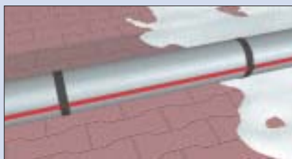
10 Przewód grzewczy można do rurociągu zamocować prostoliniowo (rys. Elektra)
