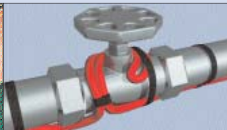
11 Takie zamontowanie przewodu grzewczego samoregulującego na zaworze umożliwia jego demontaż (rys. Elektra)
