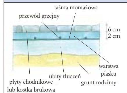
6 Pod chodnikiem z płyt lub kostki brukowej stałoporowe przewody układa się w warstwie piasku 2-3 cm możliwie blisko płyt
