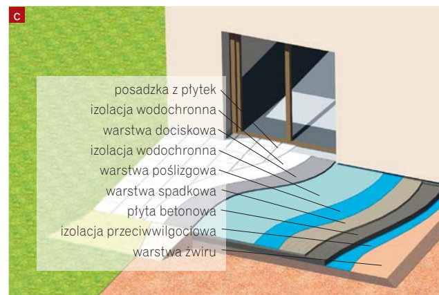
Schematy tarasów na gruncie: ziemny z nawierzchnią trawiastą (a), z nawierzchnią utwardzoną kostką (b), na płycie betonowej (c)
