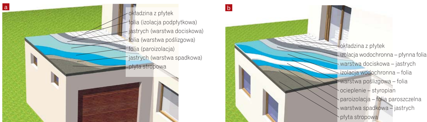
Tarasy nad pomieszczeniami: nieogrzewanym (a), ogrzewanym (b)
