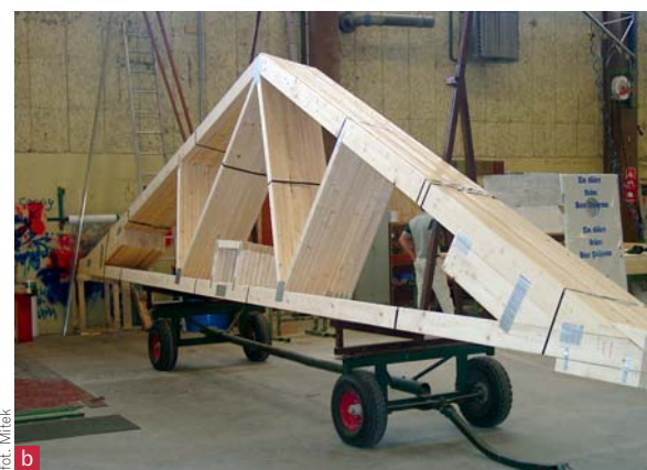
▲ (a) Więżba dachowa wykonana przez cieśli na budowie i (b) prefabrykowana, wykonana w fabryce z dźwigarów drewnianych łączonych za pomocą płytek wielokolcowych
