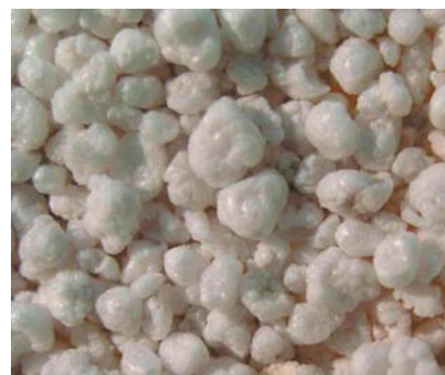
6 Poddany działaniu wysokiej temperatury perlit pokrywa się warstewką szklisa (fot. Zakłady Górniczo-Metalowe Zębice) ▲
