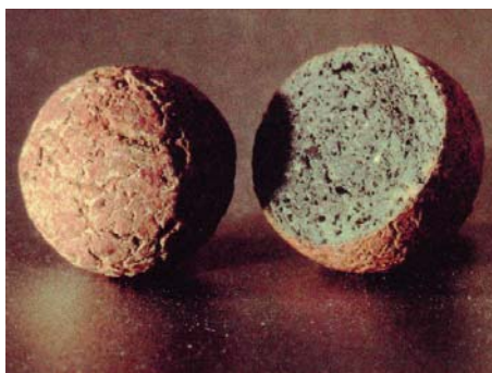
5 Granulki keramzytu są wewnątrz porowate (fot. Grema Ekosystem) ▲
