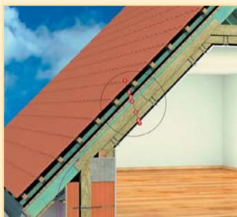
Dwuwarstwowe ocieplenie połaci dachowej poddasza użytkowego typu szczelnego dla pary wodnej,
