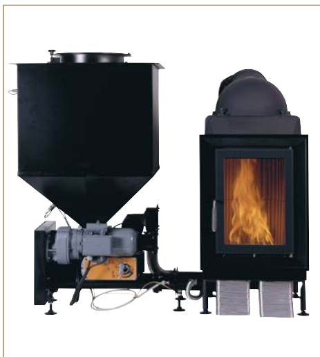
▲ Wkład kominkowy zasilany peletami z zasobnikiem o pojemności 123 kg – wystarczającej na 5–6 dni pracy kominka
