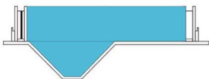
▲ Basen betonowy wkopany w ziemię, wykonany z paneli polimerowych
