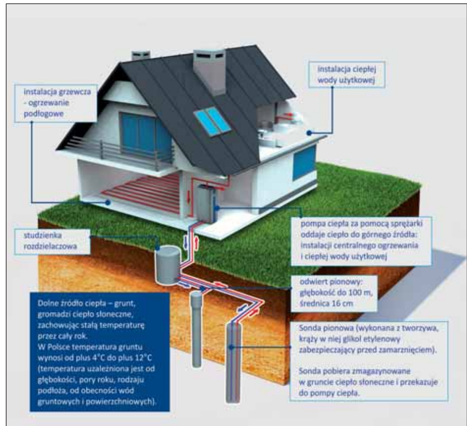
Działanie gruntowej pompy ciepła
