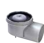
Practicus z PP, z syfonem, przepustowość 1,8 l/s, wysokość zamknięcia wodnego 50mm
