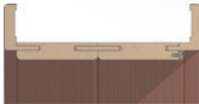
Ościeżnica dla grubości muru od 340 mm składa się z co najmniej dwóch elementów
