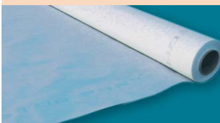
Regulator antykondensacyjny jest odpowiednikiem FWK o wysokiej paroprzepuszczalności; zapewnia powolne przenikanie pary i zapobiega powstawaniu skroplin (fot. Marma Polskie Folie)
