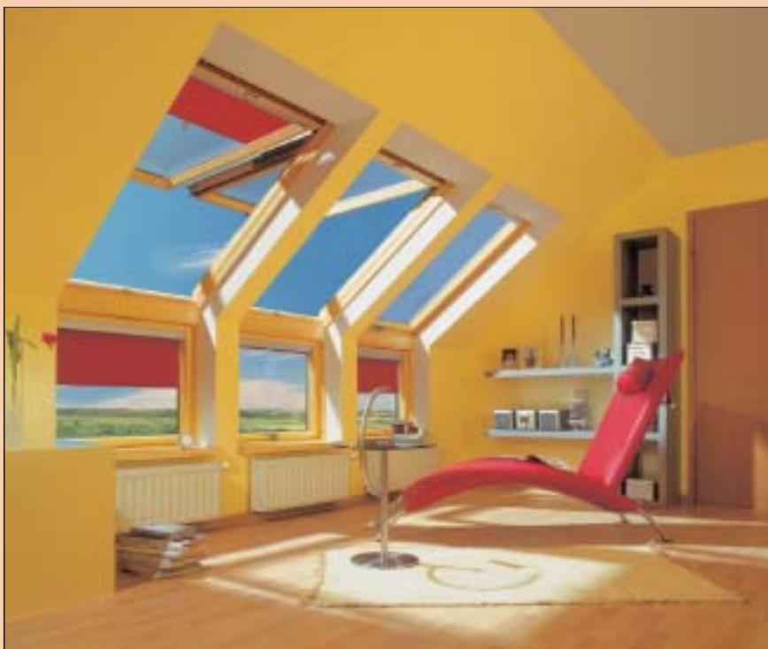
5 W ścianie kolankowej umieszcza się okna pionowe, nad nimi zaś najczęściej połaciowe; widoczna na zdjęciu roleta skutecznie ogranicza ilość światła w pomieszczeniu (fot. Fakro)
