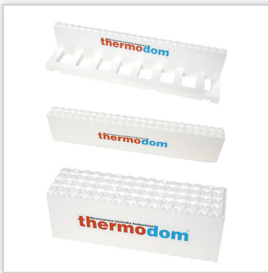
Elementy wieńcowe. Elementy zapewniające utrzymanie wysokiej izolacyjności cieplnej w niewaligicznych miejscach ścian, jakimi są wieńce stropowe i miejsca posadowienia murłat. Aprobaty: Europejska Aprobata Techniczna.
