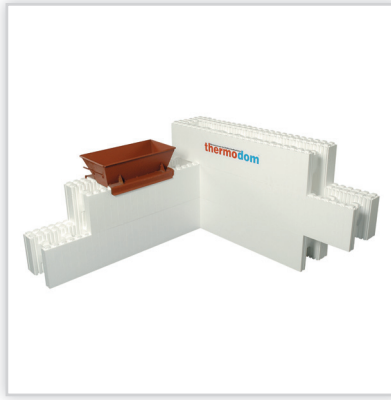
System ścienny TH300. Elementy do wznoszenia ciepłych ścian budynków energooszczędnych i pasywnych oraz ścian fundamentowych. Doskonały współczynnik przenikania ciepła U_0 [W/m 2 K]: <0,20. Grubość ścian [cm]: 30. Zużycie betonu [m 3 /m 2 ]: 0,122. Aprobaty: Europejska Aprobata Techniczna. Cena netto [zł/m 2 ]: 130.
