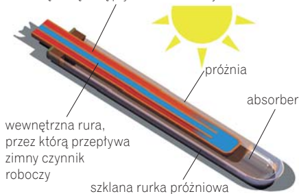
Przekrój rury kolektora próżniowego z bezpośrednim przepływem czynnika roboczego
