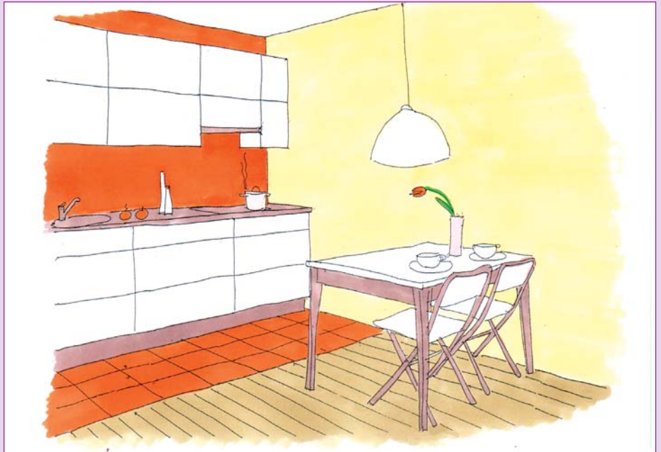
Wąski pas terakoty ułożony przed szafkami kuchennymi zmniejsza jej powierzchnię. Stół stoi już na podłodze „pokojowej”
