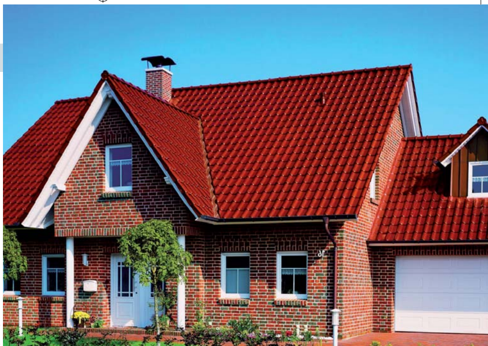
▲ Dachówki ceramiczne najlepiej układać na dachu o kącie nachylenia 16-44°
