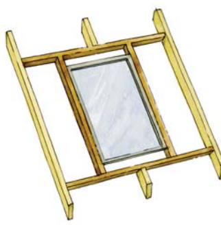
Zastosowanie wymianów – okno znacznie mniejsze lub większe od rozstawu krokwi
