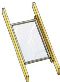
Nadbiecie wyciętej krokwi – okno nieznacznie większe od ich rozstawu
