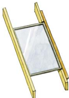
Pogrubienie krokwi – okno nieznacznie mniejsze od ich rozstawu
