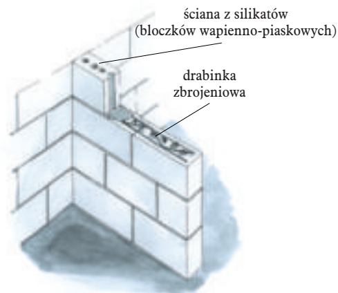
13 Sposób murowania i zbrojenia silikatowych bloczków drążonych
