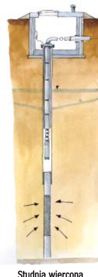
Studnia wiercona z pompą głębinową
