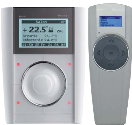
▲ Centralny panel oraz pilot sterujący. Umożliwiają one obsługę urządzeń zintegrowanych z instalacją inteligentną, np. rolet, oświetlenia, ogrzewania, wentylacji
