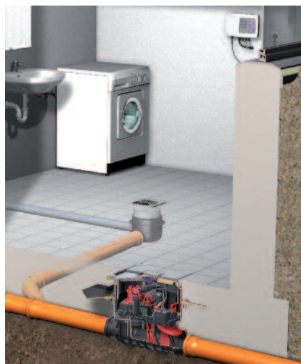
■ Przykład zabudowy w płycie podłogowej
