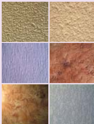
Faktura tynku zależy od jego składu i narzędzia użytego do fakturowania (fot. Jafep Polska)
