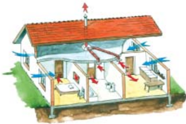
4 Dom z wentylacją mechaniczną wyciągową
