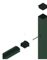
Łączenie słupa końcowego
