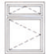
okno dzielone z częścią uchylną (tzw. lufcik) i rozwieralną
