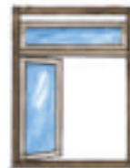
okno dzielone z częścią uchylną (tzw. lufcik) i rozwieralną
