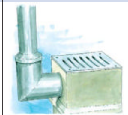
8 Połączenie bezpośrednie rury spustowej ze studzienką odpływową
