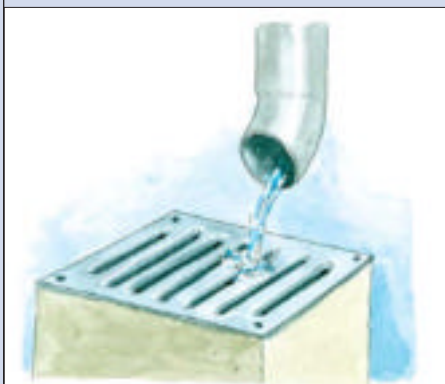
7 Odprowadzenie wody z rynien do studzienki odpływowej podłączonej z kanalizacją burzową – wylot wody na ruszt
