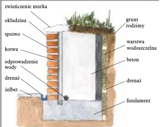
3 Schemat murka masywnego
