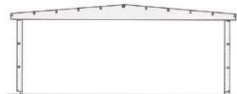
KONSTRUKCJA SŁUPOWO-RYGLOWA TYPU DWUTRAPEZ
