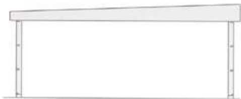
KONSTRUKCJA SŁUPOWO-RYGLOWA JEDNOTRAPEZOWA
