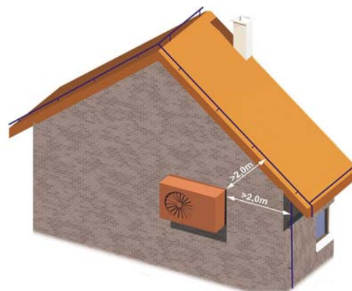
Rys. 4. Na rysunku pokazano minimalne odległości, które trzeba zachować pomiędzy elementami instalacji odgromowej a urządzeniami umieszczonymi na elewacji. Inaczej może dojść do ich uszkodzenia i pożaru
