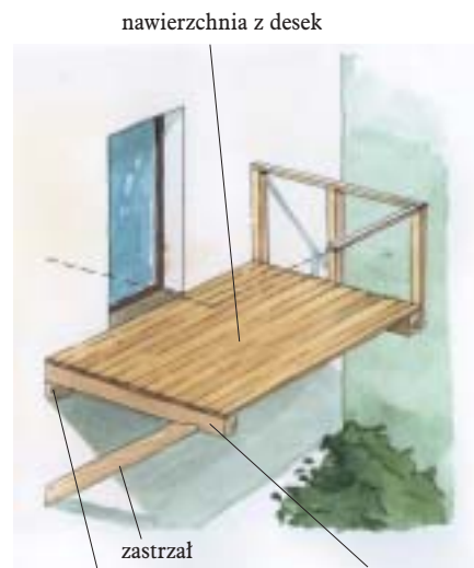
belka podtrzymująca, przymocowana specjalnymi łącznikami do konstrukcji domu
