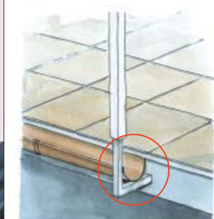
10 Tak zamocowana balustrada nie narusza warstwy hydroizolacji
