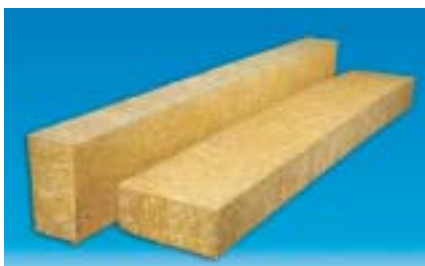
Bardzo nowoczesnym materiałem są płyty lamelowe z wełny mineralnej. Charakteryzują się uporządkowanym, prostopadłym do powierzchni płyty układem włókien, co zwiększa ich wytrzymałość. Dzięki dużej elastyczności można nimi ocieplać powierzchnie łukowe (fot. Paroc)
