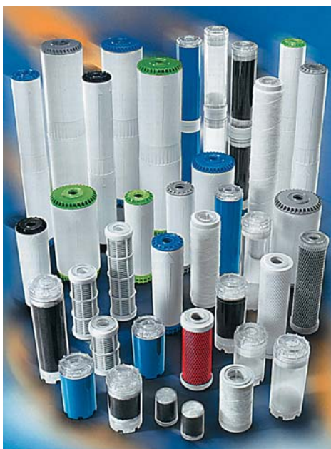
▲ W filtrach węglowych stosuje się między innymi wkłady z węgla z łupin orzecha kokosowego w postaci granulowanej lub spiekanej. Służą one do usuwania substancji organicznych, woni, barwy, metali ciężkich, związków chloropochodnych
