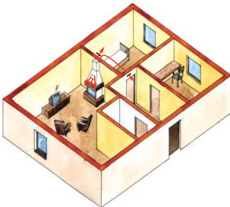
6 Tak działa system konwekcyjny. Część ciepłego powietrza ogrzanego w kominku wypływa przez kratkę w obudowie kominka bezpośrednio do pomieszczenia, w którym zbudowany jest kominek. Sąsiednie pomieszczenia ogrzewane są powietrzem doprowadzanym przez system kanałów
