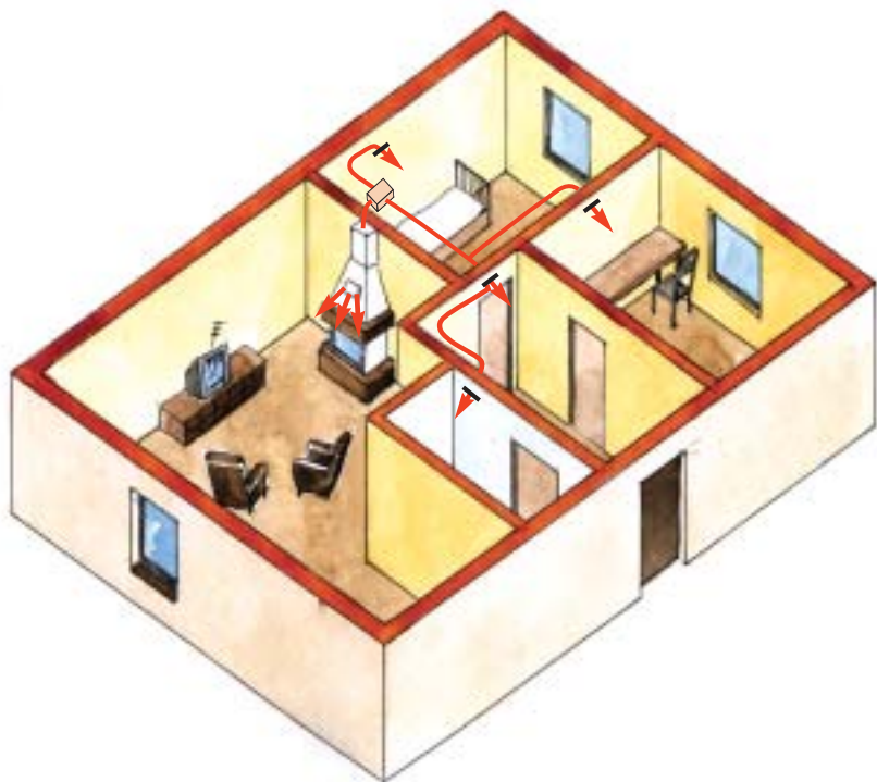
7 System DGP z wykorzystaniem wentylatora. Ogrzane powietrze jest tłoczone przez wentylator do kanałów, którymi jest rozprowadzane do dowolnych pomieszczeń w domu. W obudowie kominka jest także umieszczona kratka nawiewna
