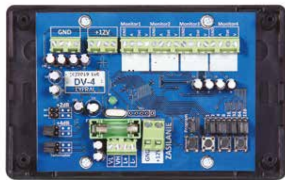
Dystrybutor DV-4 w obudowie z tworzywa ABS Wymiary obudowy: 131 x 81 x 34 [wys. x szer. x gł.]
