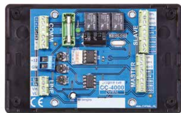
Moduł elektroniki CC4000 w obudowie z tworzywa ABS 131 x 81 x 34 [wys. x szer. x gł.]
