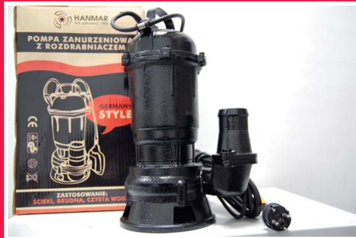
Pompa do wody brudnej bez pływaka WQD 10-8 Moc: 3000 W Maksymalna wydajność: 18 m 3 /h Wys. podnoszenia cieczy: 21 m
