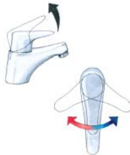
4 Tak wygląda regulacja temperatury i strumienia wody w baterii jednouchwytowej – obracanie uchwytem w płaszczyźnie poziomej zmienia temperaturę wody od ciepłej (z lewej strony) do zimnej (z prawej strony), a wychylenie pokrętki do góry zwiększa strumień płynącej wody
