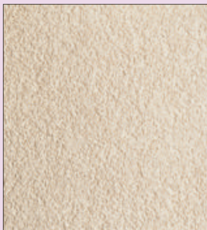
5 Faktura kamyczkowa lub gresowa jest lekko chropowata. Uzyskuje się ją przez rozpraszanie masy tynkarskiej pacą z tworzywa sztucznego (fot. Henkel)
