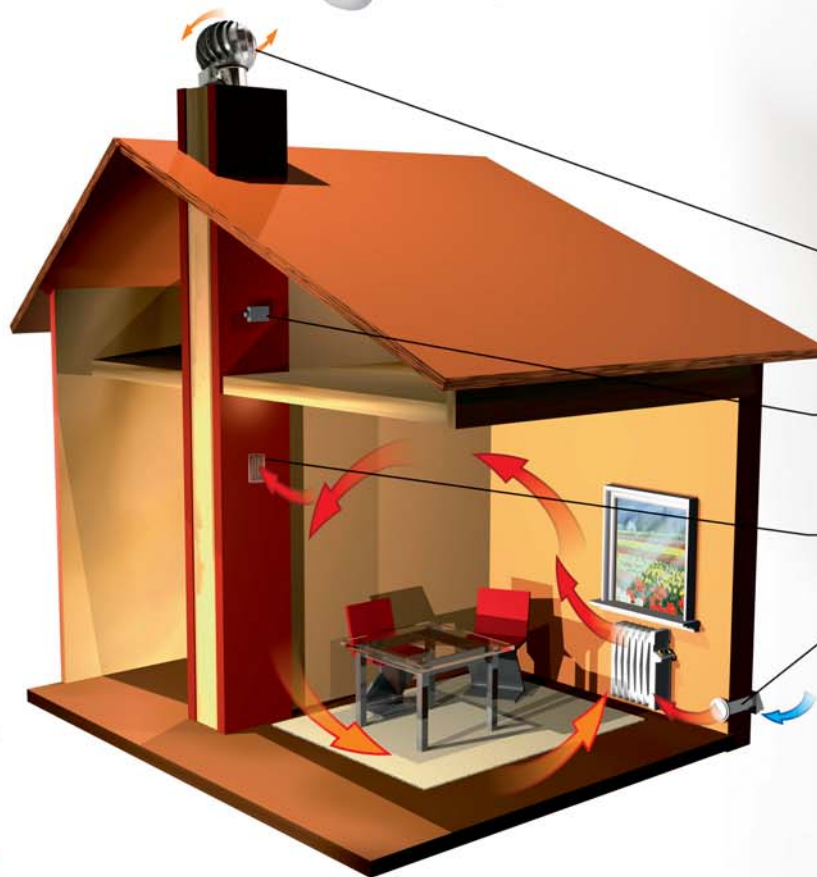
nawietrzak z grzałką „nawiew powietrza z jego wstępnym podgrzaniem!”
