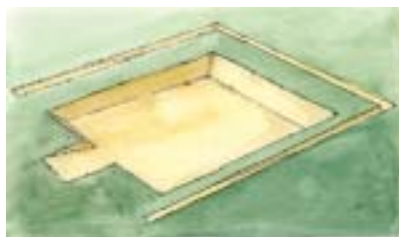
Rowek drenażowy odprowadza wodę opadową od wykopu
