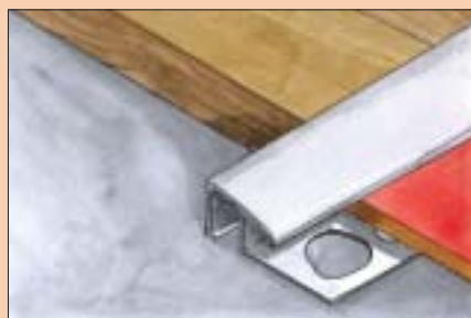
6 Okucie niwelujące na styku parkietu z posadzką z płytek ceramicznych
