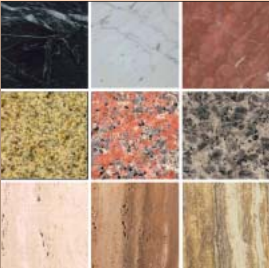
1 Przykłady płytek kamiennych, od góry: marmur, granity, trawertyny ( www.stonegallery.hg.pl )
