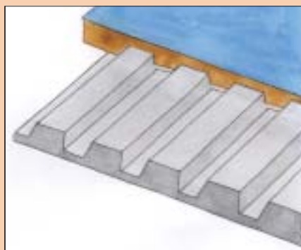
9 Układanie płytki na zaprawie przegarniętej pacą zębatą
