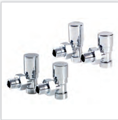
Komplety zaworów kątowych do podłączenia grzejnika PERFEXIM LTD (a.7030 i 7040) przeznaczone do montażu grzejników w instalacjach c.o. (w tym również grzejniki łazienkowe). Wchodzący w skład zestawu zawór zasilający służy do regulacji strumienia czynnika grzewczego, natomiast zawór odcinający ma za zadanie zamknięcie przepływu czynnika grzewczego przez grzejnik. Dane techniczne: maks. temp. robocza: +100°C; maks. ciśnienie robocze 1,0 MPa (10 bar); gwinty przyłączeniowe 1/2.
