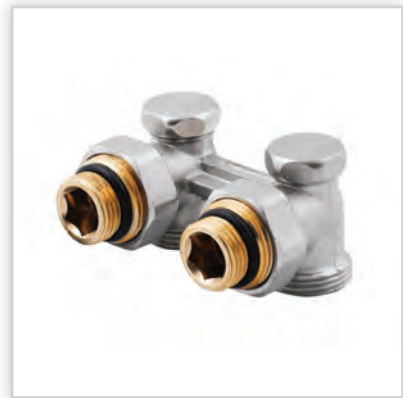
Zespół zaworów kątowych (ze złączką redukcyjną) do grzejników dolnozasilanych PHA-035. Specjalna końcówka stożkowa umożliwia montaż zespołu do grzejników dolnozasilanych z gwintami zewnętrznymi, natomiast niple służą do montażu zespołu z grzejnikami dolnozasilanymi z gwintami wewnętrznymi. Do podłączenia grzejników z gwintami G1/2. Skład kompletu: zespół zaworów kątowych oraz złączki redukcyjne (niple redukcyjne).
