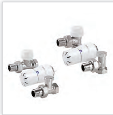
Komplety termostatyczne: prosty (a. PHA-026) oraz kątowny (a. PHA-027) z nastawą wstępną do podłączenia grzejnika. Skład kompletu: zawór grzejnikowy termostatyczny prosty lub kątowny z nastawą wstępną (art. PHA-028 lub art. PHA-029), zawór grzejnikowy odcinający prosty lub kątowny (a. PHA-031 lub a. PHA-033), głowica cieczowa termostatyczna art. GS.05.
