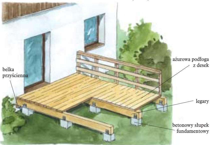
6 Drewniany taras na legarach, wsparty na betonowych słupkach
