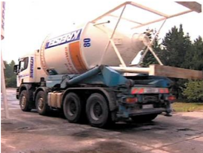
Fot. 17 Silos przewożony jest do jednego z zakładów produkcyjnych firmy KREISEL i ponownie napełniany.
