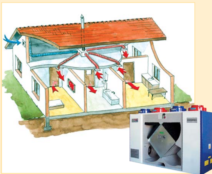
Sprawną wentylację niezależnie od warunków pogodowych zapewni instalacja wentylacji mechanicznej – najlepiej z rekuperatorem (fot. Koss)
