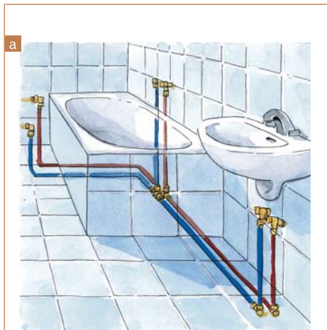
Dwa sposoby prowadzenia instalacji: (a) trójnikowy; (b) rozdzielaczowy
