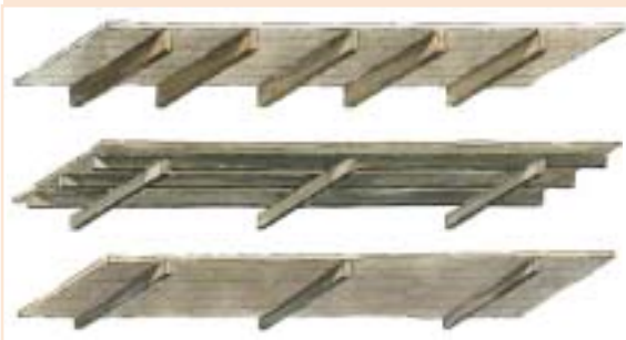
G Stropy drewniane, od góry: gęstożebrowy, belkowo-żebrowy, belkowy
