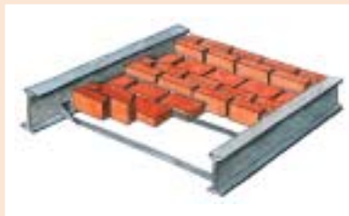
F Strop Kleina (na stalowych belkach dwuteowych)
