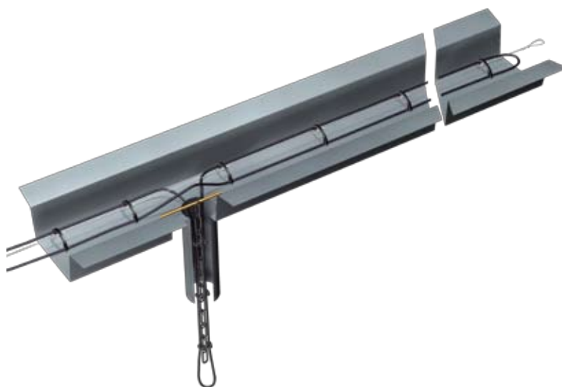
Ogrzewanie przeciwooblodzeniowe rynny i rury spustowej za pomocą Comfort Kabla (kabla rezystancyjnego)
